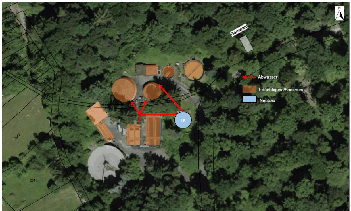
Abbildung 1: Erweiterung der Kläranlage Aichelberg Variante 1
