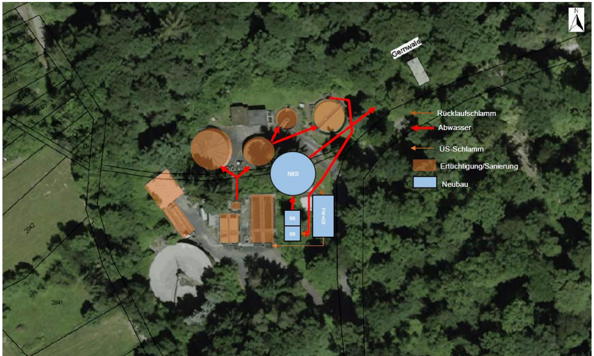
Abbildung 5: Erweiterung der Kläranlage Aichelberg Variante 3
