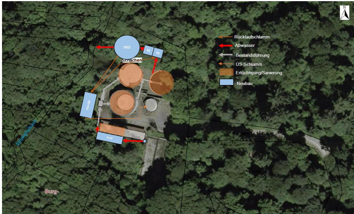
Abbildung 9: Erweiterung der Kläranlage Schanbach Variante 2
