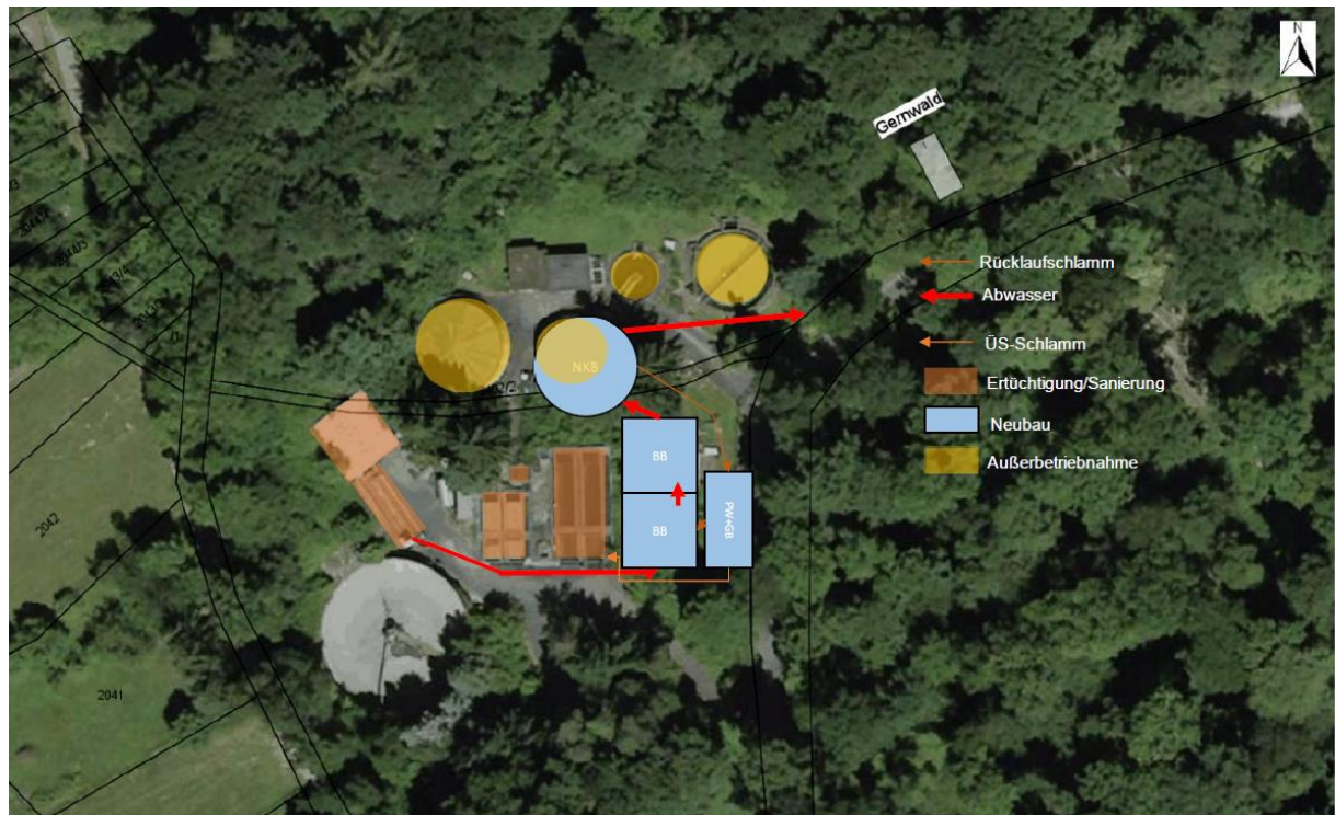
Abbildung 6: Neubau der Kläranlage Aichelberg Variante 4.1
