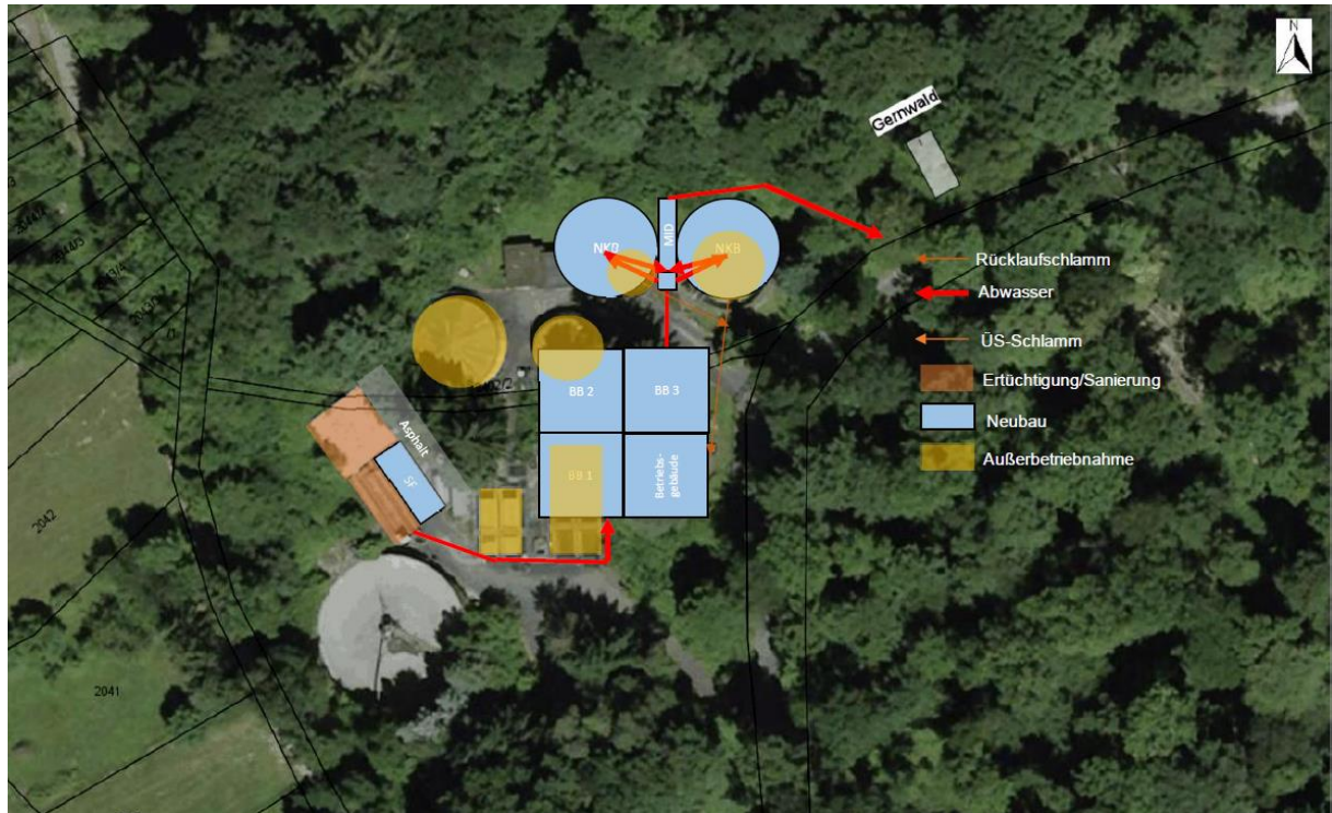
Abbildung 17: Neubau der Kläranlage Aichelberg Variante 5.1
