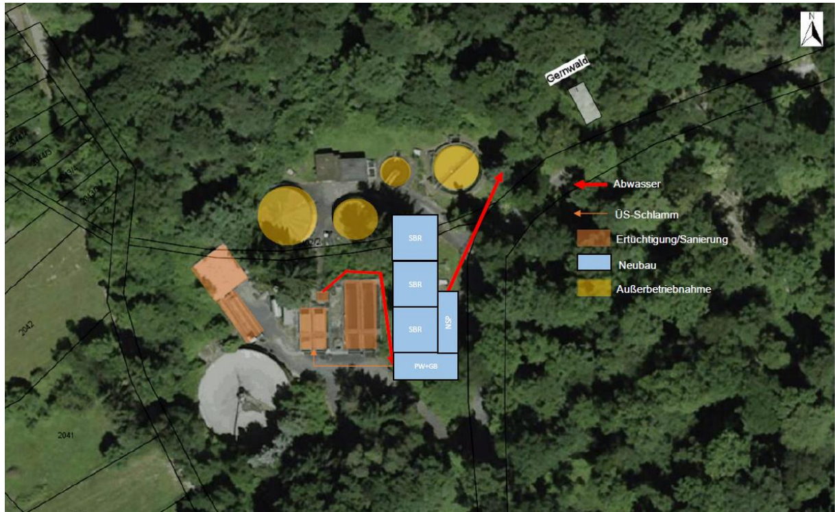
Abbildung 7: Neubau der Kläranlage Aichelberg Variante 4.2
