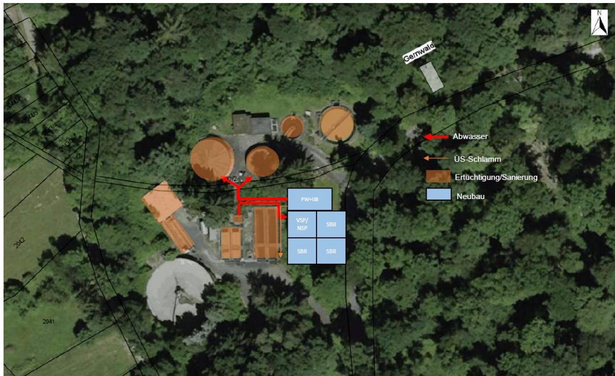
Abbildung 4: Erweiterung der Kläranlage Variante 2.2
