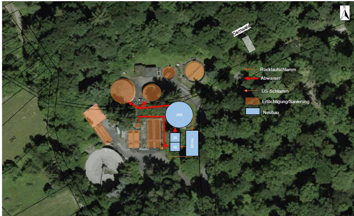
Abbildung 2: Erweiterung der Kläranlage Aichelberg Variante 2.1
