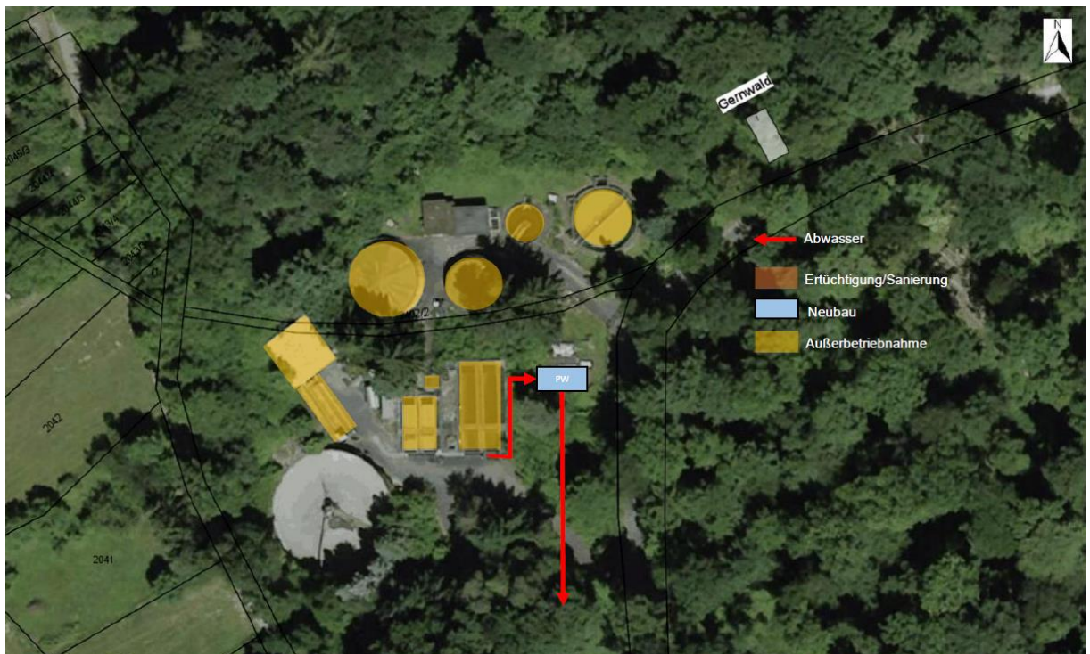
Abbildung 23: Pumpwerk der Kläranlage Aichelberg Variante 6
